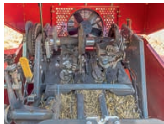
Ο βασικός εξοπλισμός περιλαμβάνει έναν ανεμιστήρα αυτόματης αναστροφής, για να διατηρείται καθαρή η περιοχή δεσίματος.
