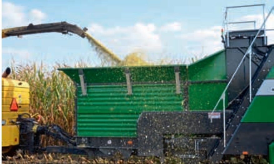
Αναφέρεται ότι ο αποθηκευτικός χώρος 8 m³ είναι αρκετά μεγάλος για να επιτρέψει το συνεχές δεμάτιασμα/συσκευασία όταν χρησιμοποιείται σε συνδυασμό με μια κεφαλή καλαμποκιού.
