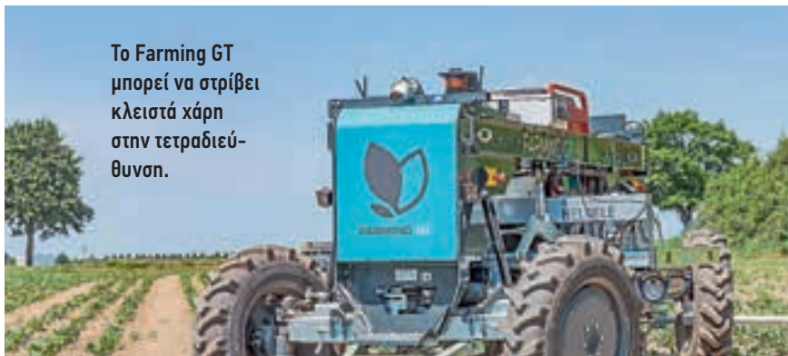
Τα περιστρεφόμενα εργαλεία κόβουν και τα μεγαλύτερα ζιζάνια στη σειρά τεύτλων.
