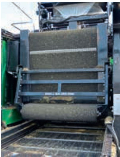
Ο θάλαμος δεματιού, που κατασκευάστηκε στη Γερμανία, παράγει δεμάτια με διάμετρο 1 μ. -1,15 μ. x 1,2 μ. πλάτος (όγκο 1,25 m³).
