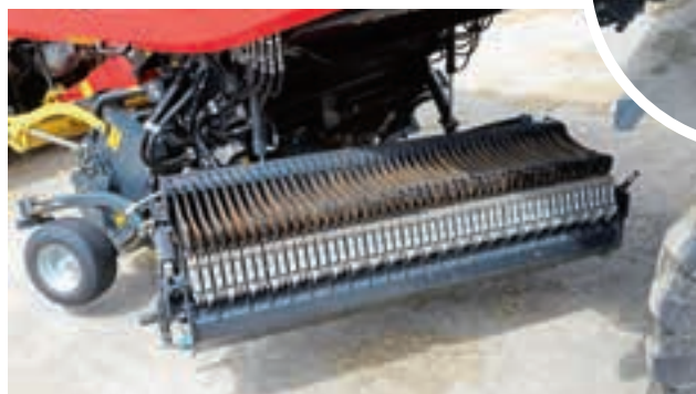
Η βάση μαχαιριών περιστρέφεται προς την αριστερή πλευρά για εύκολη πρόσβαση, ενώ όλα τα μαχαίρια απελευθερώνονται μέσω ηλεκτρικά.
