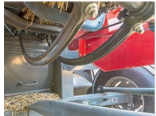
Αφού χαλαρώσουν δύο βίδες, το κανάλι τροφοδοσίας μπορεί να ανοίξει από το πίσω μέρος για τυχόν μπλοκαρίσματα.
