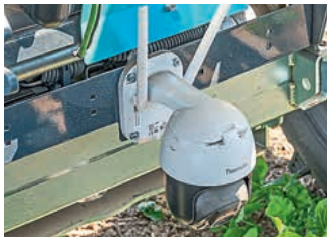
Η κάμερα παρακολουθεί το αποτέλεσμα της ζιζανιοκτονίας που επιτυγχάνεται από το Farming GT και μετακινείται μέσα από το κινητό.
