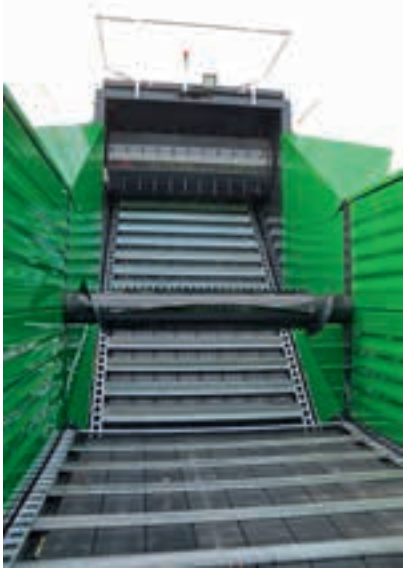
Το κινούμενο δάπεδο μεταφέρει το καλαμπόκι από τον αγωγό στο πίσω μέρος του αποθηκευτικού χώρου του XL.
