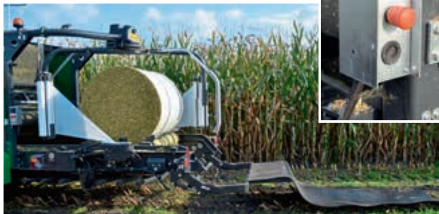
Η συσκευαστική κατασκευάζεται από την Agronic, αλλά με τις προδιαγραφές της Knoll. Οι διπλοί βραχίονες τυλίγματος διαθέτουν 750 χλστ. μεμβράνης.
