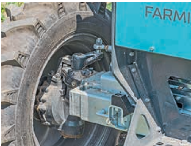
Κάθε τροχός μπορεί να στρίβει, ενώ το μετατρόχιο προσαρμόζεται.
