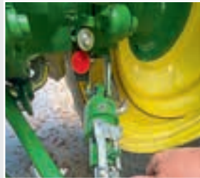
Οι σταθεροποιητές είναι υδραυλικοί, αλλά η αλλαγή της κατηγορίας πλάτους ζεύξης είναι μηχανική.
