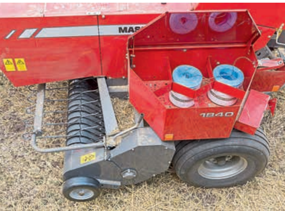
Τα ανθεκτικά κουτιά του σπάγκου στα δεξιά και στα αριστερά χωράνε και τα δύο πέντε ρολά.
